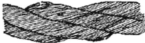
Рисунок 10.1. Обрывы и смещения проволок каната крестовой свивки
