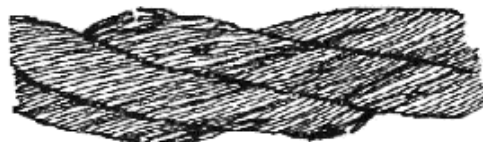
Рисунок 10.1. Обриви та зміщення дротів каната хрестової звивки
