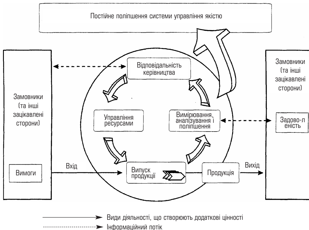
Рисунок 1. Модель системи управління якістю, що базується на процесному підході
